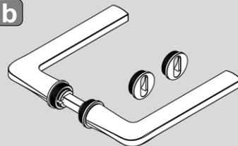
Die Rosetten erlauben nur eine sehr geringe Toleranz, daher ist eine präzise Türbearbeitung erforderlich!
